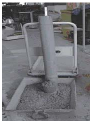
高流動コンクリート実験風景
