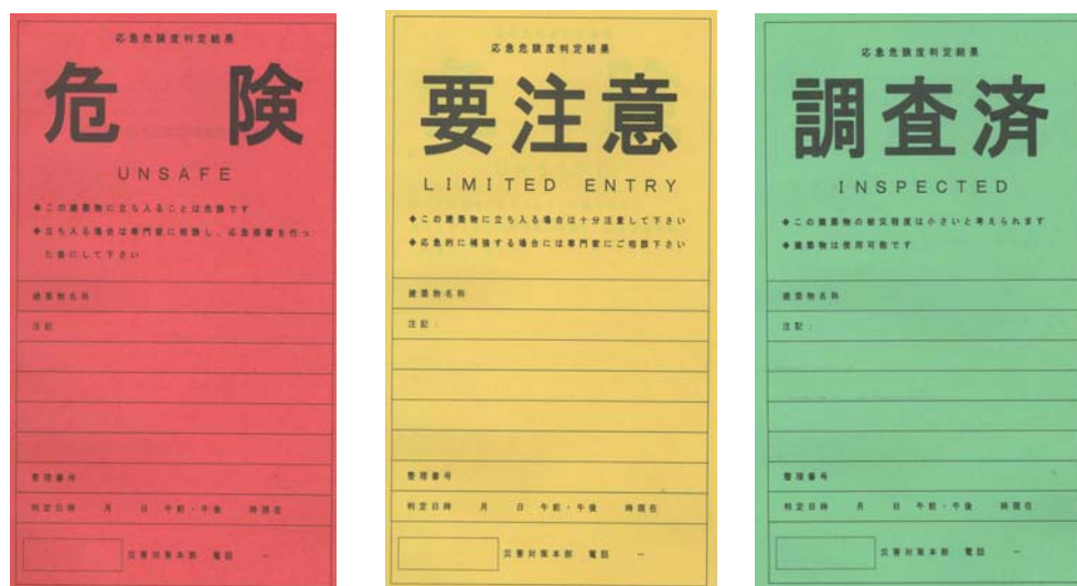
写真 1.1-1 応急危険度判定ステッカー
