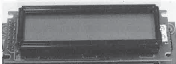
図9 16文字x2行表示の液晶
