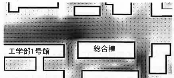
図12 風速ベクトルの水平分布 (総合棟周辺, 風向N, 高さ1.5m)
