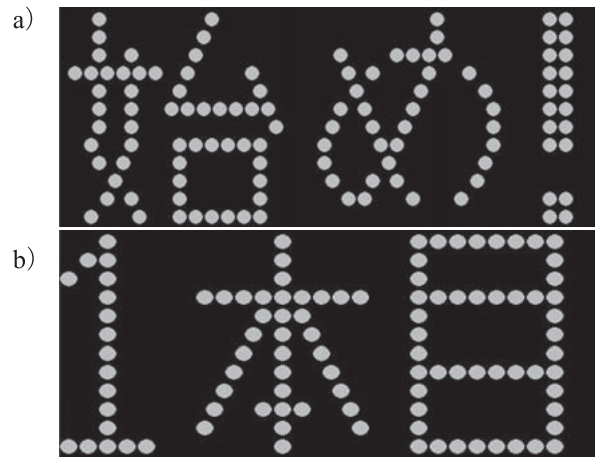
Figure 7 実験時の画面出力の例。a) はシステムが振り始めと認識したとき、b) は振り終わりと認識したとき画面に出力される。なお、b) の数字部分には何回目の試技であるかが入る。
