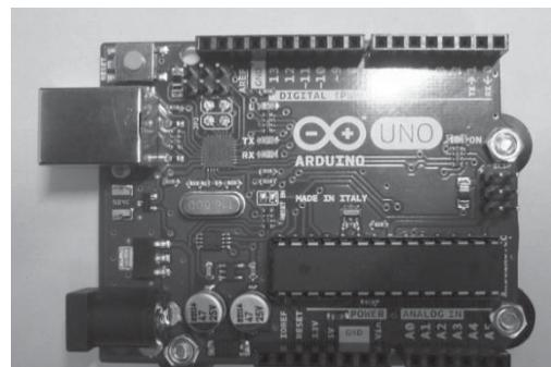
Fig.4 Arduino Uno R3 の外観
