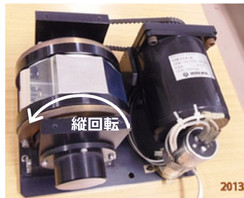
図 7 回転角速度 353\text{ rad/s} の回転ミラー
