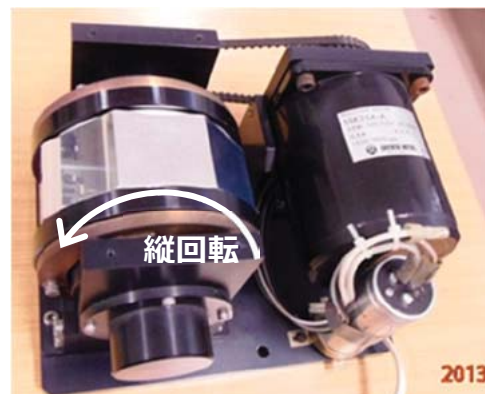
図 7 回転角速度 353 \text{ rad/s} の回転ミラー
