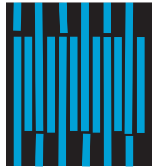
図5 長い分子鎖により上下をかみ合わせた初期配置の模式図. 突出させた分子鎖は周期境界を跨いでいる.
