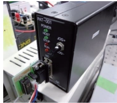
Fig.11 PAT-001 と RS232C/TTL 変換回路
