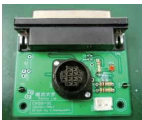
Fig.10 D-sub 25P と MINI-CA 12P の変換回路
