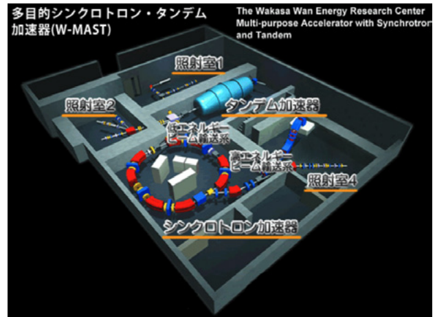
図 2. 多目的シンクロトロン・タンデム加速器 本測定においてはタンデム加速器から発生する \alpha 線および陽子線を測定した． また，測定は照射室 1 にて行った．
