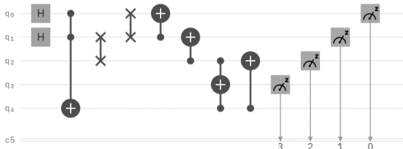
図 3 3 の乗算回路。IBM の量子コンピュータへ送信した回路(Transpiling 前)。
