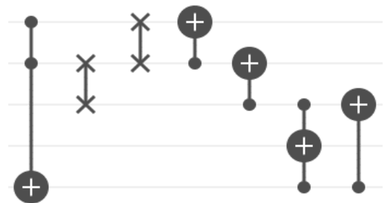
図 2 (2^n+1) の乗算回路(n は自然数). n=1 の例.
